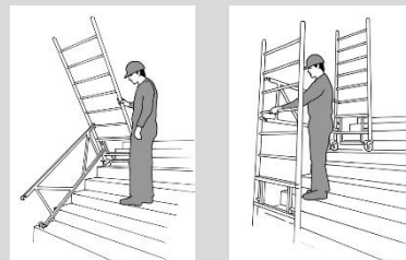
Schéma : Verrouillage des crochets bascules
