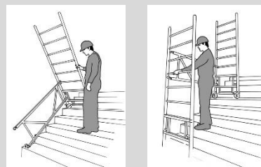
Schéma : Verrouillage des crochets bascules
